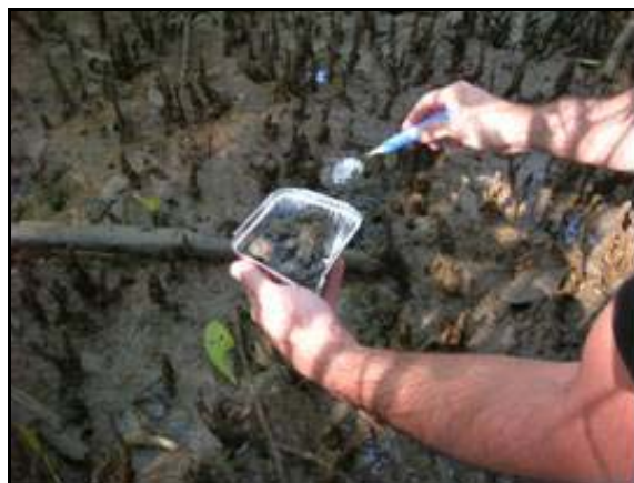
Figura 6.4.6-4 - Coleta de material para análise de Hidrocarbonetos Poli Aromáticos
